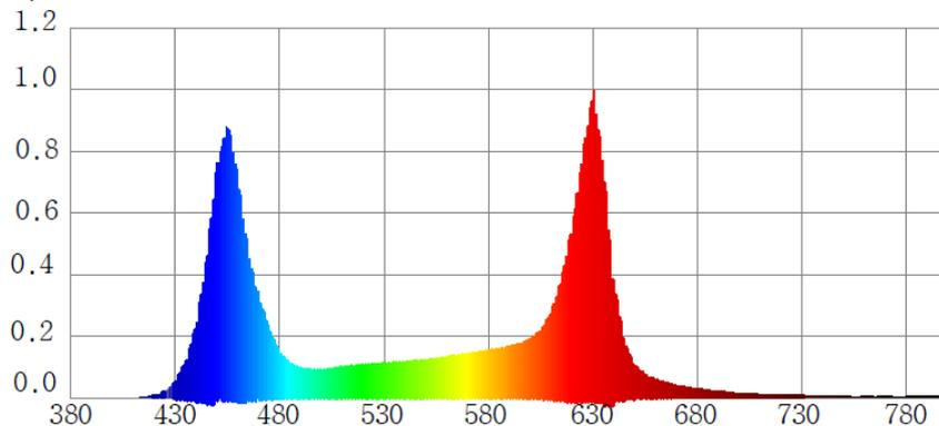
**B: METOLIGHT® MEAT-P:** Hier wird das rosa Licht direkt aus einzelnen speziell beschichteten SMD LED Dioden erzeugt. Die Farbintensität ist geringer als bei der RBW-Variante und **optimal für helles Fleisch** wie z.B. Schweinefleisch geeignet. Im Vergleich zur RGW-Variante ist hier der Rotanteil im Lichtspektrum deutlich reduziert und flacher abfallend.
