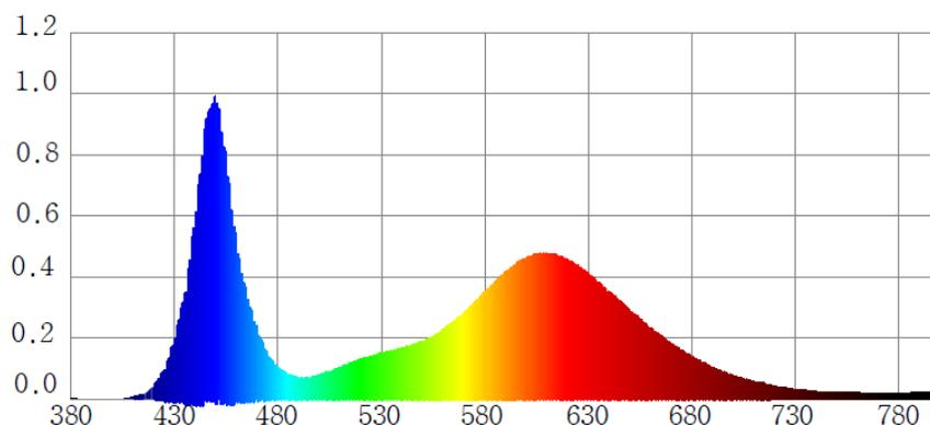
**C: METOLIGHT® MEAT-TR:** Wie bei der Variante P wird das rosa Licht aus speziell beschichteten SMD-LEDs erzeugt, wobei die die Farbgebung noch etwas geringer ist. Diese Farbe ist **ideal für helles Geflügelfleisch**.
